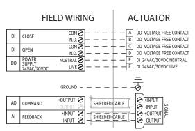
THE COMMAND SIGNAL IS FACTORY WIRED FOR 3 WIRE (POWER LIVE, POWER NEUTRAL, COMMAND SIGNAL POSITIVE). THE JUMPER WIRE FROM COMMAND SIGNAL NEGATIVE TO POWER NEUTRAL CAN BE REMOVED FROM THE NXT CONTROL MODULE FOR 4 WIRE USE.
